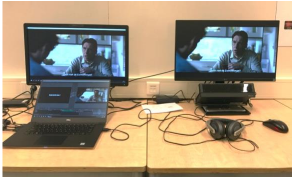
Figuur 4: De testopstelling met aansturing van de scènes via OBS.
