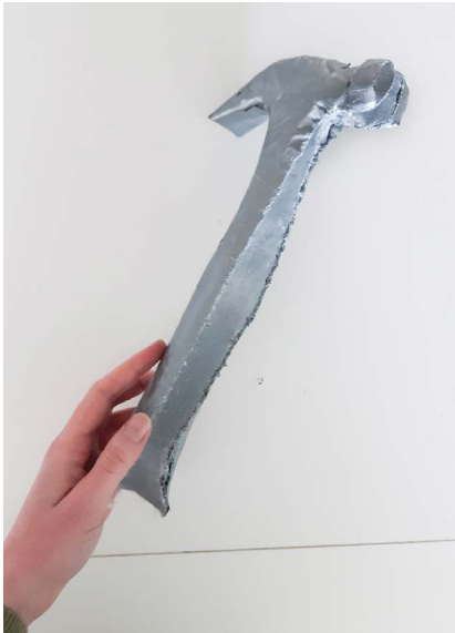
Figuur 20: een mal gemaakt van duct-tape.
